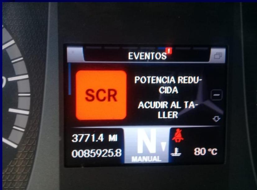
Mal funcionamiento del sistema de Inyección de Urea: inyector obstruído, falta de fluído, falla del sistema eléctrico, etc
